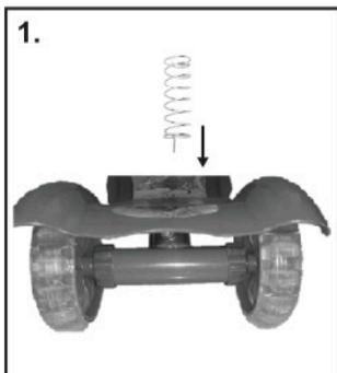
1. Monte as rodas traseiras no eixo e as prenda com as porcas. Encaixe a mola entre o eixo das rodas e a parte plástica para montar o freio.
