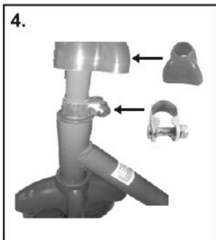
4. Encaixe a abraçadeira metálica no garfo da roda dianteira para prender o guidão ao garfo. Aperte a abraçadeira e a cubra com a proteção plástica
