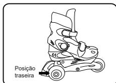
1 – Remova as 2 rodas da posição traseira utilizando as chaves allen para soltar os parafusos que as prendem.
