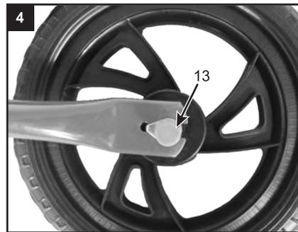
4. Encaixe a proteção do eixo (13).
