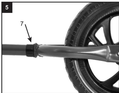
5. Na base do garfo, encaixe um dos anéis de proteção do quadro (7).
