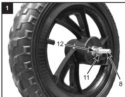
1. Passe o eixo (8) pelo rolamento (6) e o centralize com a roda (5). Encaixe o separador (12) e depois a porca da parte interna (11). Repita do outro lado da roda.
