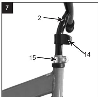
7. Coloque a abraçadeira (15) no tubo do garfo. Coloque a capa de proteção (14) no tubo do guidão (2) e encaixe o guidão (2) no garfo.
