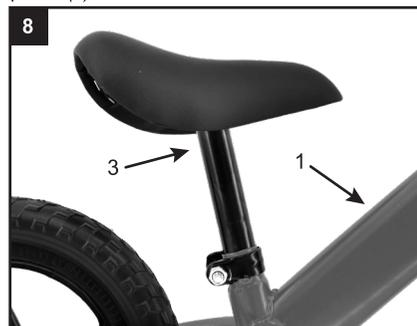
8. Encaixe o selim (3) no quadro (1) e o aperte com o auxílio da ferramenta para fixá-lo.
