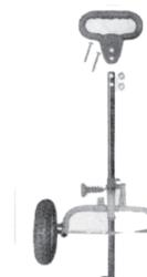
4. Encaixe a haste de direção no buraco do quadro principal e fixe com um parafuso. Fixe o pegador da haste de direcionamento com dois (02) parafusos.
