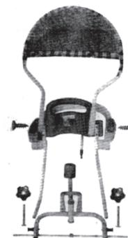
6. Fixe o encosto no quadro principal com o auxílio de dois (02) parafusos. Fixe a capota no encosto com dois (02) parafusos.
