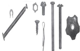
Parafusos, porcas, travas metálicas, grampos plásticos, pino de acoplamento
