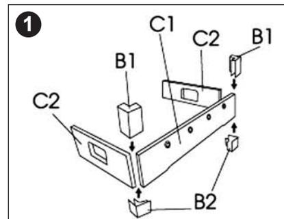
Encaixe 2 peças C2 à uma peça C1 utilizando 2 cantoneiras B2 na parte inferior e 2 cantoneiras B1 na parte superior.
