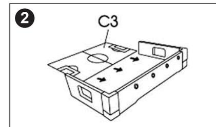
Deslize a peça C3 através dos encaixes das peças C2.
