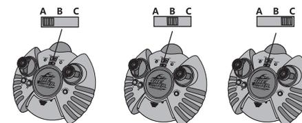
3. Em seguida, ajuste o canal do carro para corresponder com o do controle (certifique-se de fazer a correspondência da frequência uma por uma). Mude a chave ON/OFF do carro e do controle para a posição ON.
