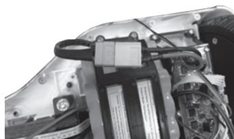
4. Após conectar, verifique se ficou bem encaixado e firme, ajeite os fios, encaixe a tampa do hoverboard e com a chave philips, comece à aparafusar os 12 parafusos para fechar (os parafusos estão no saquinho).
