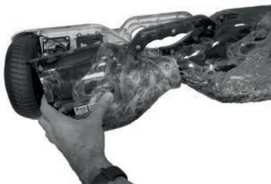
3. Depois de removida a tampa, localize o conector da bateria. Quando localizar, segure as duas partes e as encaixe.
